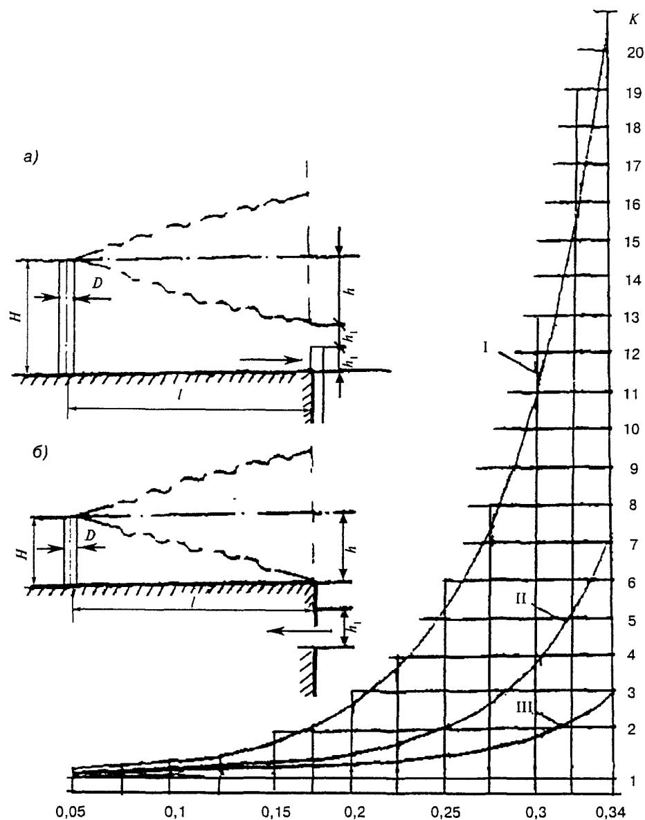
*a* - расположение источника над зоной всасывания наружного воздуха приемным устройством (высота трубы
